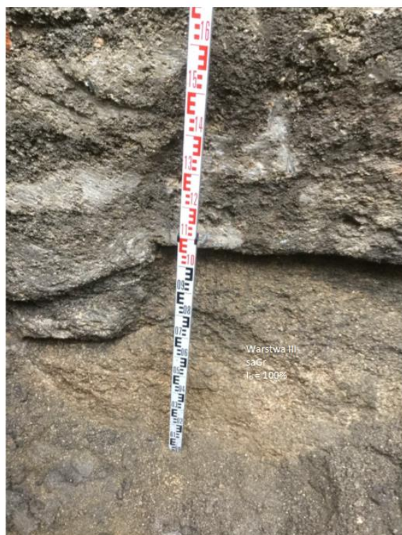
Zdjęcie nr 1. Odkrycie fundamentu. W poziomie posadowienia znajduje się zwietrzały granit saGr.
