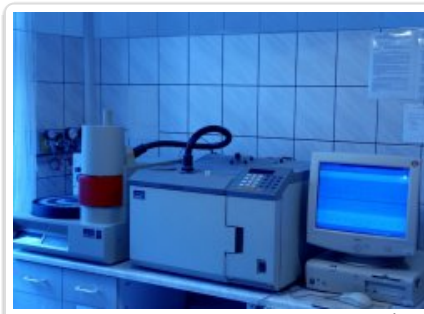
Aparat używany do oznaczania zawartości alkoholu etylowego w próbkach krwi.
