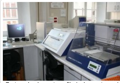
Zestaw do chromatografii cienkowarstwowej TLC Sampler 4 wraz z TLC Scannerem 3 firmy Camag
