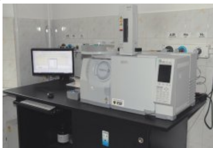
Chromatograf gazowy z detektorem masowym GC_MS QP2010 firmy Shimadzu
